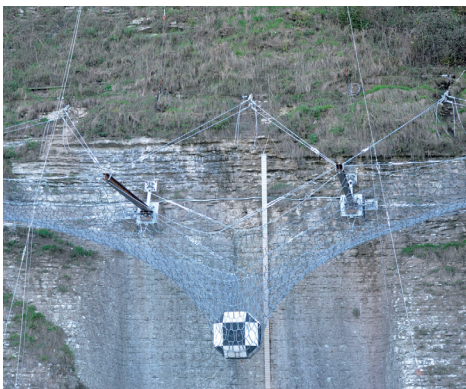
Prueba de impacto de caída de rocas en un modelo de tamaño natural
