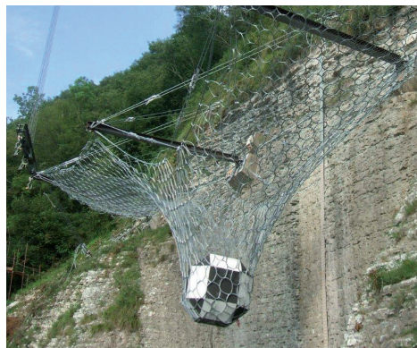
Prueba de impacto de caída de rocas en un modelo de tamaño natural
